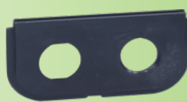
Un perçage dia 21 avec méplat de 19.6 pour connecteur, et un pour presse étoupe M20x1.5
