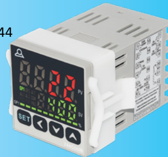
Régulateur électronique 48 x 48, double affichage Tout ou rien et PID auto-tune, multi capteur, sortie contacteur et relais statique
